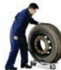
RULLI CON CUSCINETTI A SFERA CONSENTONO DI RUOTARE FACILMENTE LE RUOTE PER IL POSIZIONAMENTO NEI PERNI
