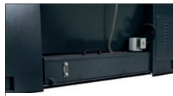
Basamento macchina in acciaio · Pompa refrigerante · Serbatoio liquido refrigerante con indicatore, rimovibile per una facile pulizia
