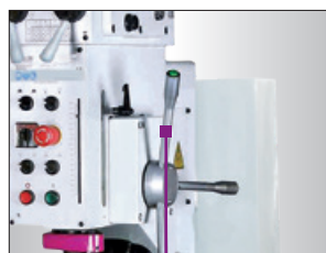
B 40GSM AVANZAMENTO AUTOMATICO CANNOTTO Per cicli di foratura profonda o per fori ciechi, l'innesto per l'avanzamento automatico del canotto può essere inserito/disinserito in ogni momento azionando il pulsante posto sull'impugnatura anteriore
