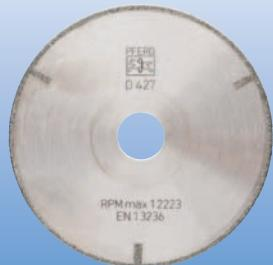
I dischi da taglio diamantati con rivestimento galvanico sono particolarmente aggressivi, grazie agli ampi spazi per lo scarico dei trucioli. Nelle granulometrie da D 64 a D 427 vengono utilizzati soprattutto per il taglio di materiali duri, come ad esempio i metalli duri o la ceramica, e i materiali plastici rinforzati con fibre (GFK/CFK).
