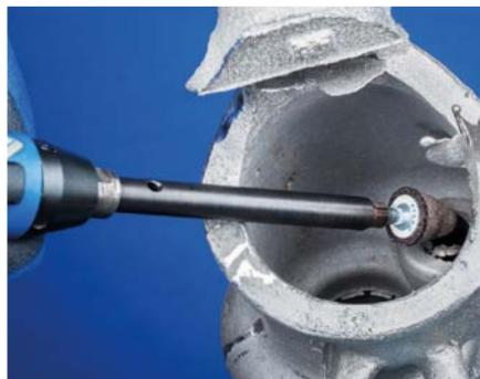
Grazie alle prolungherie è possibile allungare le mole con i diametri gambo 3, 6 e 8 mm, arrivando così a lavorare i punti difficili da raggiungere. Le prolungherie vengono montate nella pinza della macchina (pneumatica o elettrica) o nell'impugnatura dell'albero flessibile. In alcuni casi le prolungherie sono una soluzione economicamente più conveniente rispetto alla produzione su richiesta di mole con gambo lungo.
