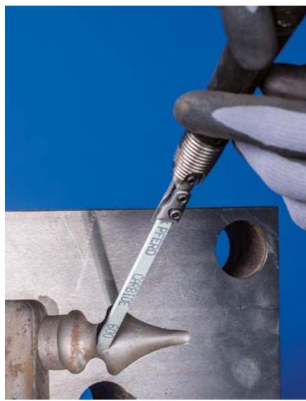
Le pietre per levigare e lucidare PFERD sono utensili molto versatili per la finitura nella costruzione di stampi e forme. Vengono utilizzate per la finitura graduale, dopo l'asportazione trucioli, o dopo l'elettroerosione (EDM), per conferire una lucidatura nella direzione di laminazione o per preparare una lucidatura a specchio con paste diamantate.
