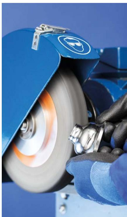
Le ruote abrasive compatte POLINOX PNK sono costituite da strisce in Vlies fortemente compresse e avvolte attorno a un nucleo. La variazione dei componenti ne migliorano la durata e il comportamento in lavoro.
