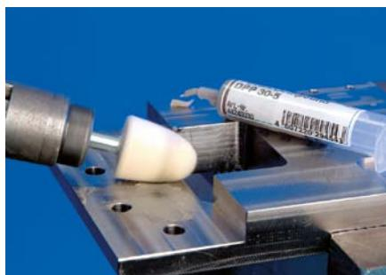
Le paste diamantate vengono impiegate per la lavorazione di materiali molto duri, ad es. il metallo duro e gli acciai temprati. Vengono utilizzate in combinazione con i filtri con gambo o i dischi in feltro. Le paste per lucidatura diamantata possono essere diluite con acqua o alcool.
