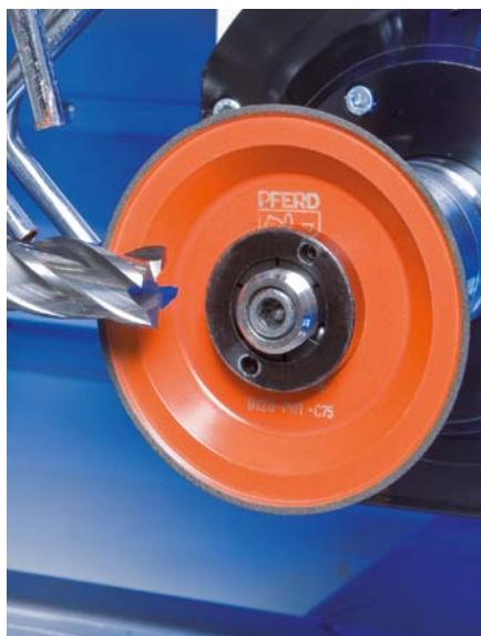
Gli utensili diamantati e CBN con legante resinoide vengono spesso impiegati per lavorare utensili in metallo duro o acciaio superrapido, ma anche in altri processi produttivi, sia nella smerigliatura a secco, sia in quella a umido.
