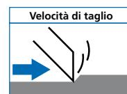
La velocità di taglio è la velocità alla quale il tagliente dell'utensile viene portato a contatto con il materiale da lavorare in direzione di taglio, rimuovendo un truciolo. La velocità di taglio V viene indicata in metri al minuto [m/min] oppure metri al secondo [m/s]. Essa dipende dal numero di giri della macchina n espresso in giri al minuto [giri/min] e dal diametro dell'utensile  $d \times \pi$  (3,14).
