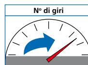
Il numero di giri n è indicato in giri al minuto [giri/min]. Il numero di giri necessario si ricava dalla velocità di taglio V in metri al minuto [m/min] oppure in metri al secondo [m/s] e il diametro dell'utensile  $d \times \pi$  (3,14).
