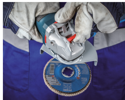
Rimuovete l'utensile azionando la leva.
