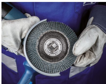
Appoggiate l'utensile sull'attacco X-LOCK.
