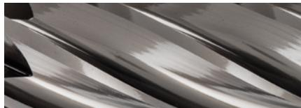
L'utilizzo di frese con il rivestimento HICOAT HC-NFE impedisce che i trucioli intasino le gole della frese durante la lavorazione di leghe di alluminio tenere. Questo favorisce una maggiore durata dell'utensile e permette di ottenere una superficie di qualità elevata.
