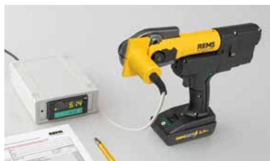
REMS dà particolare importanza al servizio: tutti i furgoni dimostrativi dei più di 200 consulenti REMS sono attrezzati con un dispositivo di prova, con il quale possono essere eseguite la prova di funzionamento e la misurazione della forza delle pressatrici radiali REMS dappertutto e sul posto.
