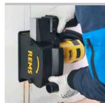
Superficie di lavoro che appoggia completamente durante l'intera operazione di scanalatura/taglio per l'affondamento guidato dei dischi diamantati, lavoro sicuro e senza polvere ed avanzamento facile ed uniforme.
