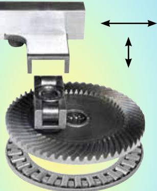
Robustissimo ingranaggio oscillante, protetto dall'acqua e dalla polvere, esente da manutenzione, per generare contemporaneamente la corsa orbitale e di taglio della biella e della lama della sega. Il manovellismo a rullini (ANC) su tutti i lati riduce l'attrito, il riscaldamento e l'usura. Si garantisce così una lunga durata anche con sollecitazioni forti a causa di tagli estremi.
