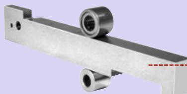
Robusta biella rettangolare in acciaio speciale massiccio, montata su cuscinetti a rullini, in modo preciso, verso la direzione di carico, guidata su tutti i lati durante l'intero avanzamento di taglio, per un taglio diritto e senza flessioni anche durante l'uso estremo con una pressione di taglio molto elevata, p.e. utilizzando una staffa di guida con trasmissione di forza. Per una durata estremamente lunga.
