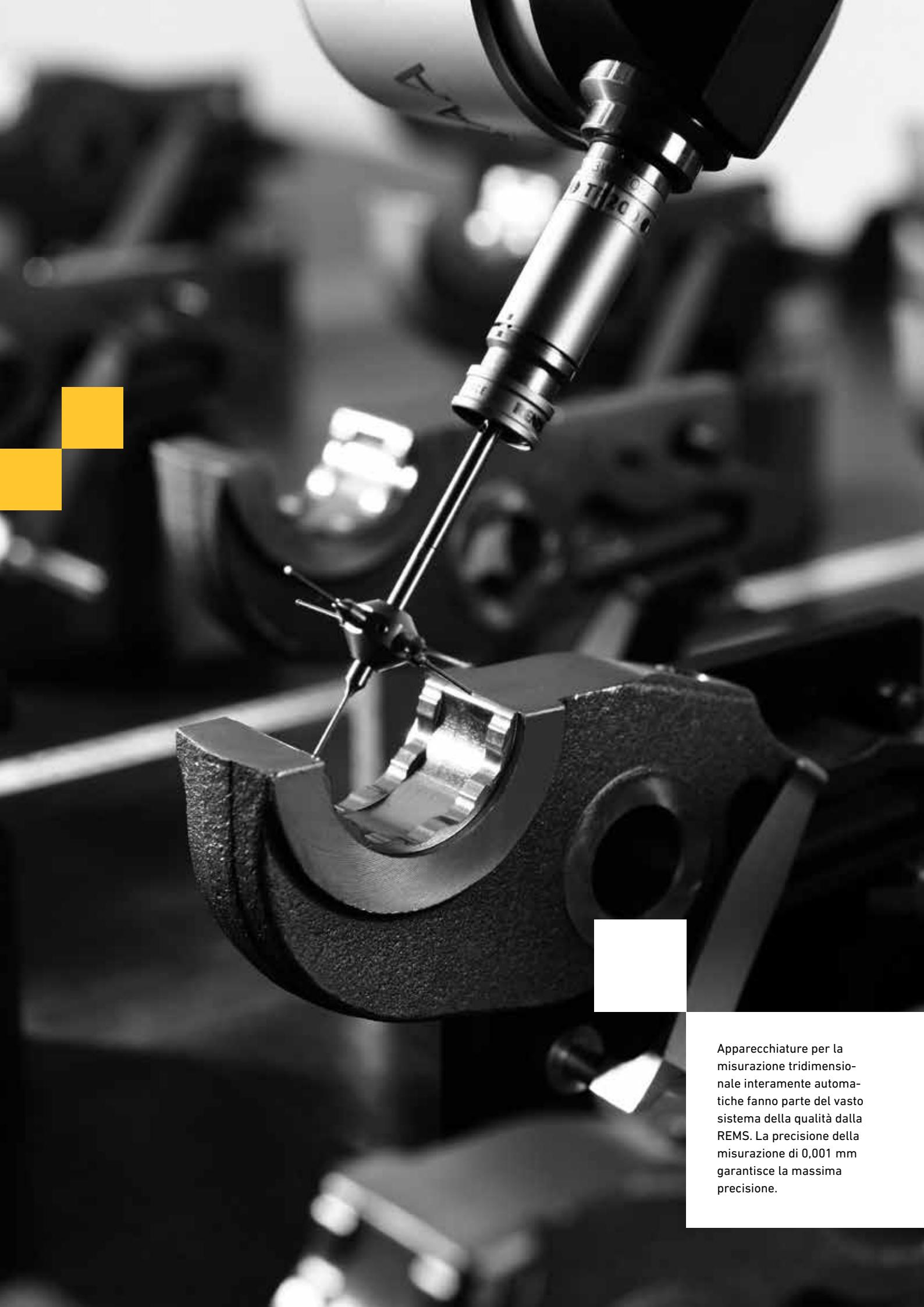
Apparecchiature per la misurazione tridimensionale interamente automatiche fanno parte del vasto sistema della qualità dalla REMS. La precisione della misurazione di 0,001 mm garantisce la massima precisione.
