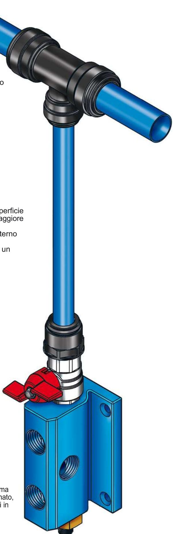
**DISTINTA PER CALATA CON TUBO IN ALLUMINIO ANODIZZATO**
