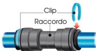
La clip riduce il movimento assiale del tubo ed assicura la massima forza di aggraffaggio delle pinzette su tubi in ottone o rame cromato, ed aggiunge una ulteriore sicurezza contro scollegamenti casuali in caso di depressurizzazione dell'impianto.
