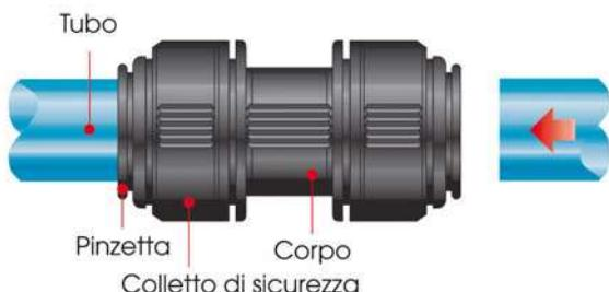
Anche questa misura ha una pinzetta con dentini in acciaio inox ed un 'O' ring per garantire il massimo aggraffaggio e tenuta. Il raccordo può essere smontato e riutilizzato senza bisogno di sostituire alcun componente.
